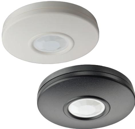
El detector PIR panorámico de bajo perfil y montaje en techo DS936 emplea un recuento de impulsos de polaridad alterna. También emplea una lente Fresnel orientable que proporciona hasta 7,5 m (24 pies) de cobertura y se puede montar en superficie o semiempotrada en un techo o en una caja eléctrica octogonal estándar.
