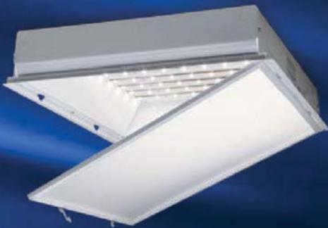
Un panel difusor con bisagras proporciona un acceso rápido y fácil. El motor de luz y el controlador pueden ser reemplazados desde abajo, sin tener que entrar en el techo o cielo raso.
