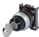
M22-WRS 2 posiciones Mantenido, Llave Removible izquierda/derecha Arillo Plateado
