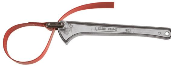
La llave de cinta Grip-It de 12" de Klein Tools se ajusta completamente a tareas en espacios reducidos de tuberías, accesorios, filtros, tubos conduit y barras de vidrio, PVC y pulidos. La cinta tiene un revestimiento de uretano que evita rayar o dañar superficies y se ajusta a un mango liviano de perfil en I. También está disponible en longitudes de 6" y 18" (Cat. n.º S6H y S18H).
