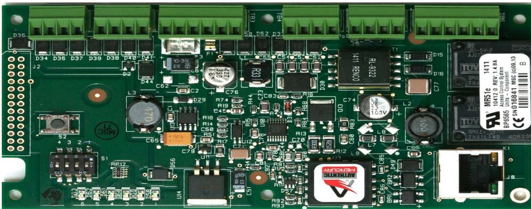
El AC-MER-CON-MR51E es un dispositivo conectado en red de alto rendimiento de alimentación a través de Ethernet (PoE) con capacidad para gestionar una (1) abertura controlada (lectores únicos o emparejados) con el sistema Access Control Manager (ACM) de Avigilon.
