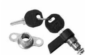
La cerradura con manija puede reemplazar la cerradura standard ranurada, de cuarto de vuelta en todos los modelos de gabinetes de tapa con bisagra o tapa con ventana. El cerrojo es de zinc fundido. Incluye dos llaves e instrucciones de instalación. Reduce la clasificación de UL de 4 o 4X a 12.
