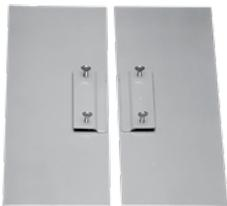
Ayudan a evitar lesiones de los trabajadores, al estabilizar los gabinetes de montaje en piso que no están fijados con pernos. Para instalar, deslice el estabilizador debajo de la base de piso y apriete los dos tornillos manuales. Hecho de placa de acero de 0.19 pulg. (5 mm). Acabado anaranjado brillante.
