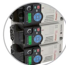
**Flexibilidad:** Todos los variadores PowerFlex serie 520 se pueden montar horizontal o verticalmente, así como uno al lado de otro en ambas orientaciones. Se requiere un juego de ventilador para módulos de control en el montaje horizontal.
